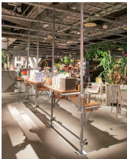
写真1: 移動可能な単管パイプ構成の什器
