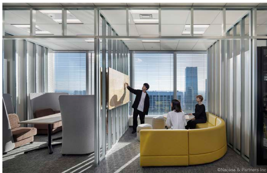
上：柱建材のフレームを表しのデザインに。将来的な意匠変更に対応でき、フレームにサインや MAP といったパーツ脱着機能も付加している。 下：同じく壁もフレーム表しに。オープンミーティングのニーズを補完しながら、将来的な会議室化も対応可能なデザイン。
